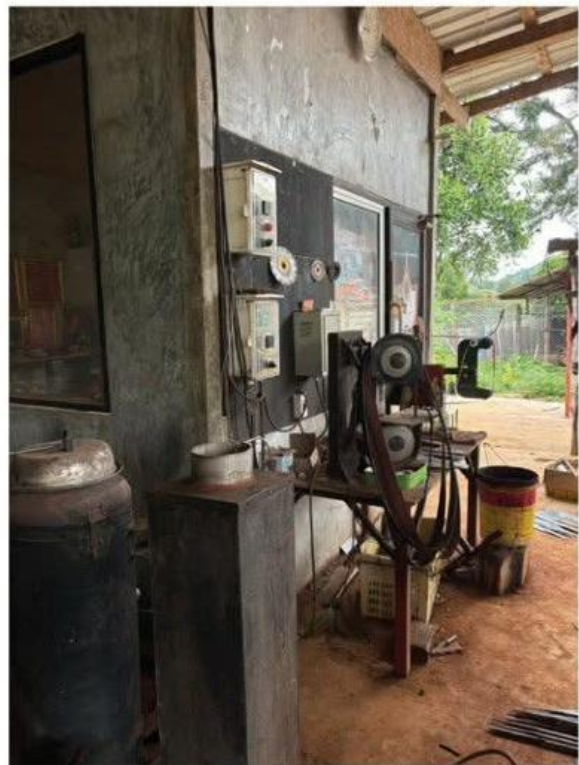
อบชุบแข็งมีดด้วยเตาปอเกลือเคมีควบคุมอุณหภูมิ
