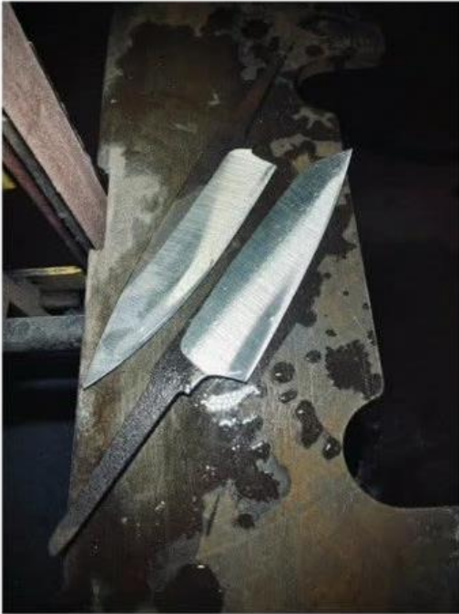
นำมีดที่ตีได้รูปทรงแล้วมาปาก ตกแต่งรูปทรง ปาดแก้มมีดให้เหมาะสมกับประเภทของมีด
