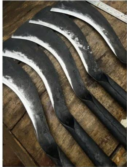
นำมีดที่ตีได้รูปทรงแล้วมาปาก ตกแต่งรูปทรง ปาดแก้มมีดให้เหมาะสมกับประเภทของมีด
